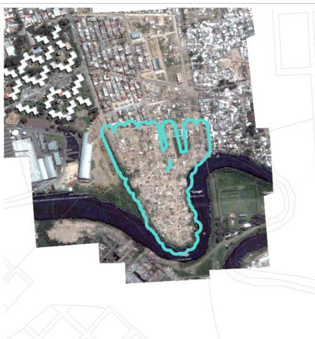
Figura 3. Creación de un buffer a partir de las líneas trazadas por el recorrido de los camiones que realizan los vuelcos ilegales. Tomamos como área un buffer de 20 metros que es lo calculado por la posibilidad de maniobra de los camiones volcadores. Llamamos a este buffer o área “huella de la basura”
