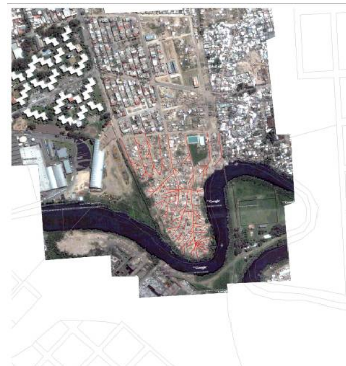
Figura 2. Imagen procesada con SIG: marcación en un schape o capa de líneas que siguen el camino de los camiones que vuelvan la basura. Esta es la primera aplicación directa del SIG sobre la imagen.
